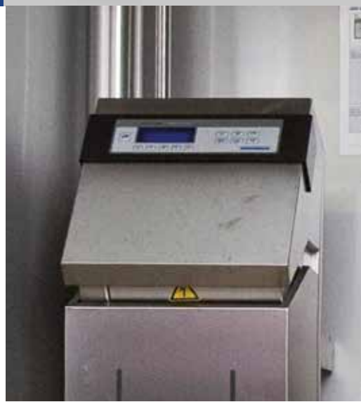
MIII Steuereinheit Deutlich lesbares Display mit Anzeige von Milchtemperatur, Datum, Zeit und Statusinformation.
